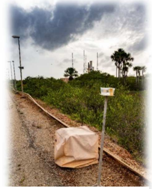
Figure 2 : Bac à eau sur son trépied métallique et SPM Honeywell sur le chemin de ronde AR5 Service OPTIQUE VIDEO CNES
